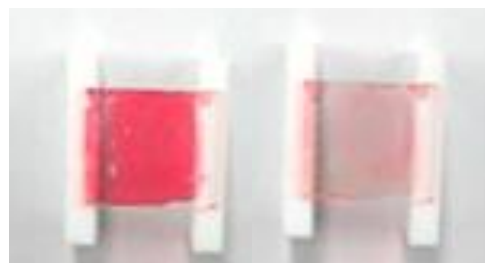
図7. MEH-PPVを導入した配向メソポーラスシリカ薄膜の異方的吸収：細孔配向方向に（左）平行、（右）垂直な偏光で観察した像
