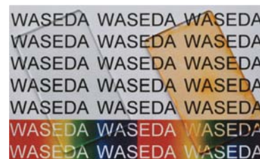
図6. ナノシートをガラス基板上にスピコートした試料(左)と、Orange IIをイオン交換させた試料(右)。(Reprinted from ref. 27 with permission; copyright 2011, American Chemical Society.)
