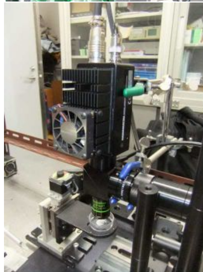
計測機器の開発風景。近赤外励起近赤外検出用二光子励起顕微鏡。
