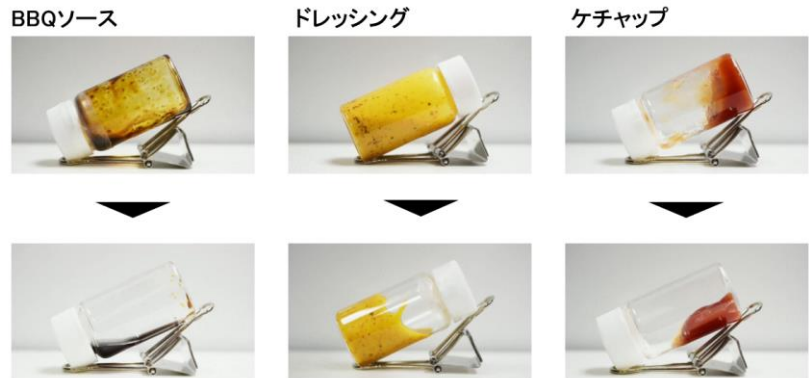
図1 開発塗料による液体付着防止技術。ガラス容器の内壁に塗布することで食品が付着せずに流れ落ちる。
