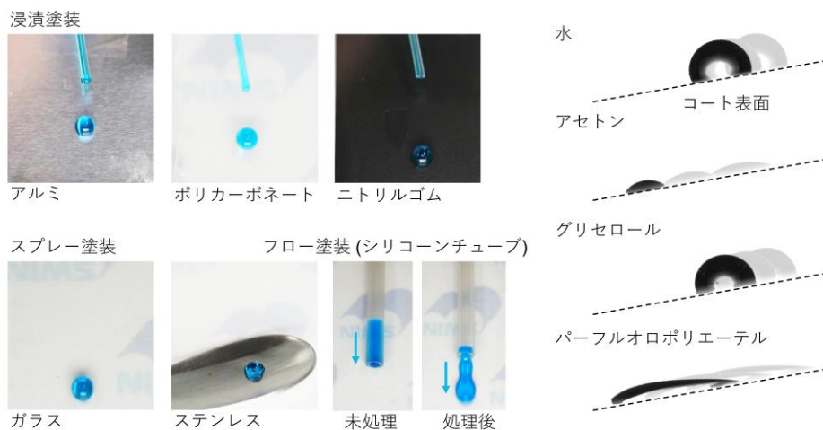
図3 開発塗料の成膜性と滑落性
