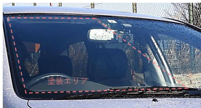
図5 車のフロントガラスへの塗装と水滴の滑落性
