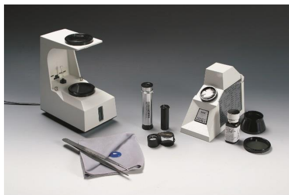
図1 伝統的な宝石鑑別道具。左上から、二枚の偏光板が上下についたポラリスコープ、回折格子型スペクトロスコープ、カルサイト結晶が埋め込まれている二色計、その手前がルーベ、宝石の屈折率を測定する屈折計と屈折液。左手前には宝石用クロスと宝石用ピンセットに青いブルーサファイヤ。VRL Asset ID 33708 Photo by Terri Weimer.
