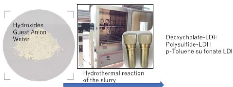
図1. スラリーを水熱処理してLDHを合成するイメージ
